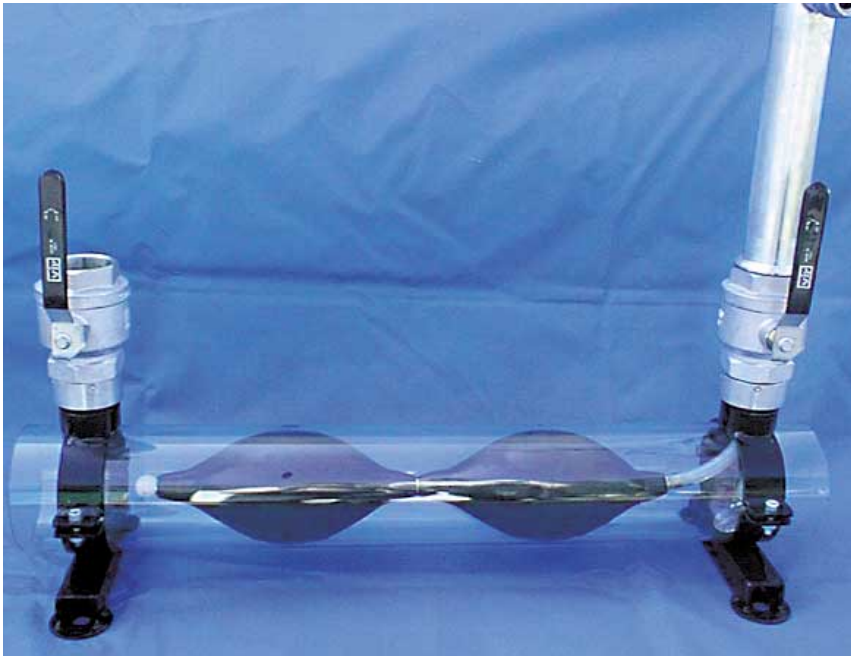
Abb. 6: Mehrdimensionale Absperrblasen (MDA) aus Gummi
