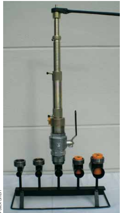
Abb. 2: Schleusenbohrgerät Maxi mit HA-Stopplesetztechnik 1-2 1/2" m. Vdr.-Messung
